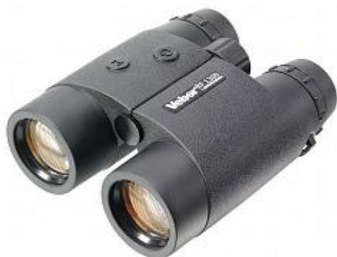
Дальность измерения до 1200 м, 4 режима измерения: стандартный, RAIN, REFL, >150 м. Бинокль 8х, диаметр объективов 42 мм. ЖК-дисплей с подсветкой, обрезиненный противоударный алюмо-магниевый корпус.
