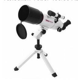
Ахроматический рефрактор (линзовый), диаметр объектива - 80 мм, фокусное расстояние - 400 мм, настольная азимутальная монтировка.
