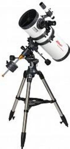
Рефлексор Ньютона (зеркальный), диаметр объектива - 150 мм, фокусное расстояние - 1400 мм, экваториальная монтировка EQ5 с механизмами тонких движений по обеим осям.
