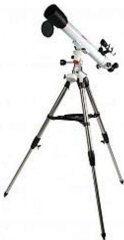
Ахроматический рефрактор (линзовый), диаметр объектива - 70 мм, фокусное расстояние - 700 мм, экваториальная монтировка EQ8 с механизмами тонких движений по обеим осям.
