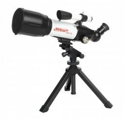
Ахроматический рефрактор (линзовый), диаметр объектива - 70 мм, фокусное расстояние - 350 мм, настольная азимутальная монтировка.
