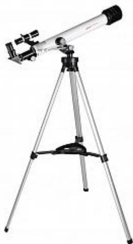
Ахроматический рефрактор (линзовый), диаметр объектива - 60 мм, фокусное расстояние - 700 мм, азимутальная монтировка, жесткий кейс.
